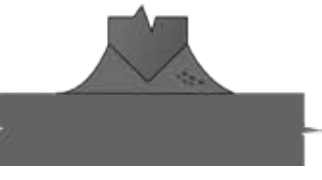
31 Porosity in Fillet (sub-surface) UT, RT
