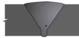
39 Porosity in Fillet (sub-surface) UT, RT
