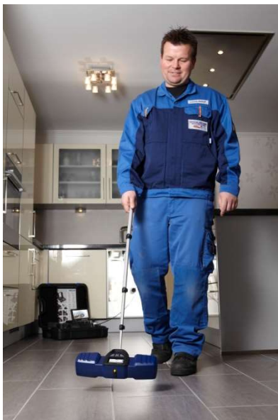
Afb. 7: Lokalisatie van de camerakop in de vloer
