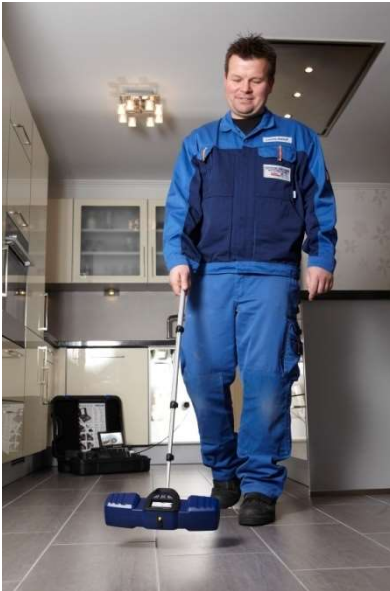
III. 6: Localisation de la tête de caméra dans le sol
