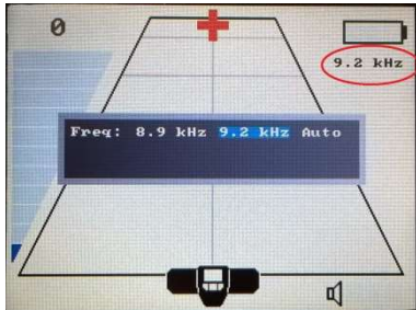
Fig. 5: Menu de Seleção de Frequência. A Frequência é mostrada no canto superior direito.
