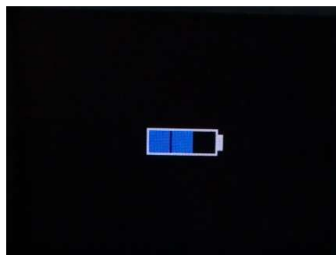
Fig. 13: Indicazione sul display durante il processo di carica quando il localizzatore è spento
